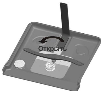
Этап 1: отвернуть фильтр грубой очистки против часовой стрелки.
