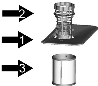
Система фильтров состоит из фильтра грубой очистки, плоского (основного) фильтра и микрофильтра (фильтра тонкой очистки).
